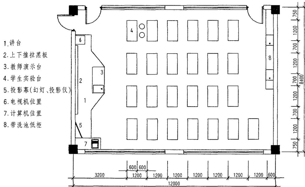
附图4 九年制学校、中学物理实验室平面布置示意图
