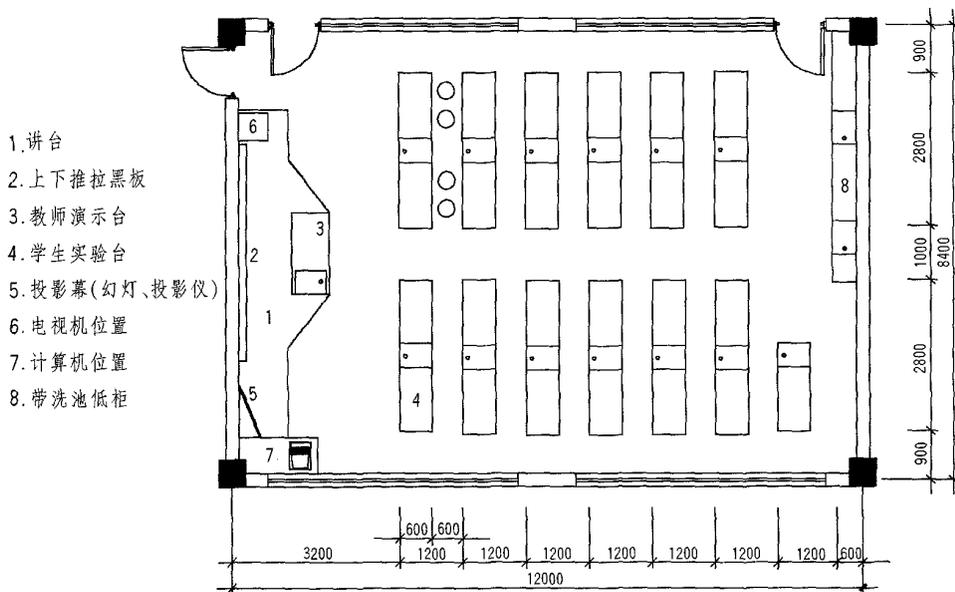
附图3 九年制学校、中学化学、生物实验室平面布置示意图
